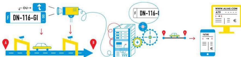
図3-42 ナンバープレート情報による課金の流れ
